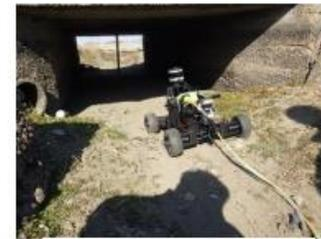
a. 橋下に入線する点検ロボット
